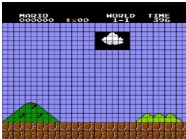
Figura 3: Esempio di tile map 8x8 utilizzata in Super Mario Bros del 1985. d'immagini, si poteva utilizzare sempre la stessa tile map memorizzata nella ROM.
